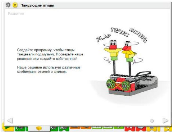
В данном занятии не требуется отклоняться от инструкций по сборке. Чтобы изменить характер движения птиц, достаточно по-другому скомбинировать систему шкивов и ремней.
