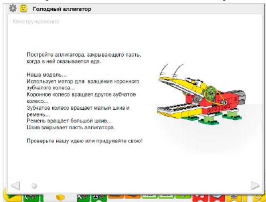
Соберите модель, следуя пошаговым инструкциям, или создайте собственную модель аллигатора. Если модель вы создаете сами, то приведенную в примере программу, возможно, потребуется изменить.
