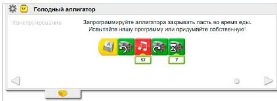
В программе «Голодный аллигатор» для включения модели используются клавиши клавиатуры (в английской раскладке). Блок «Начать нажатием клавиши» включает мотор против часовой стрелки (чтобы закрыть пасть) при нажатии на клавиатуре клавиши A.
