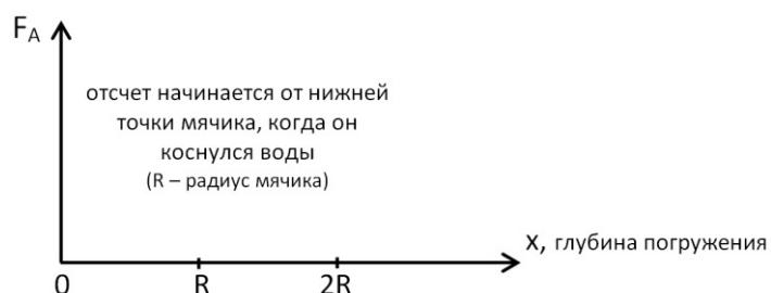
**Решение.** Сила Архимеда равна весу вытесненной воды. Вода вытесняется объемом шарового сегмента, погруженного в воду. Поэтому в идеальном случае необходимо получить зависимость объема шарового сегмента от глубины погружения шара:
