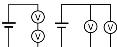
**Решение.** Обозначим:  $E$  – ЭДС источника,  $r$  – внутреннее сопротивление источника,  $R$  – сопротивление вольтметра,  $U$  – показания вольтметров (они по условию все равны). Вслед за Машей запишем закон Ома для полной цепи. Для первой схемы имеем:
